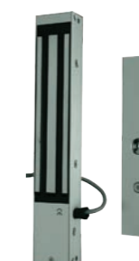
VENTOUSE APPLIQUE 300KG 24V Ventouse en applique conforme NFS61937 REF 320.1300
