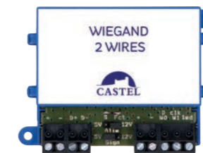
WIEGAND 2 WIRES Permet le raccordement d'un lecteur de contrôle d'accès Wiegand (26/30/34/37/56 et 58 bits) sur une centrale IPEVIA Secur 4L 2F. Max 100 mA. Gestion de la Led verte uniquement. REF 910.0143
