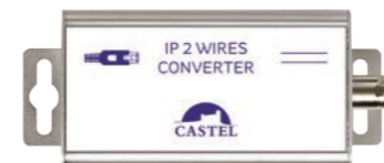
IP 2 WIRES CONVERTER Permet le raccordement d'un équipement IP distant sur 2 fils (jusqu'à 500 mètres en paire torsadée). Composé d'1 module installé en amont et connecté au switch et d'1 module installé en aval et connecté à l'équipement IP distant. REF 310.5000
